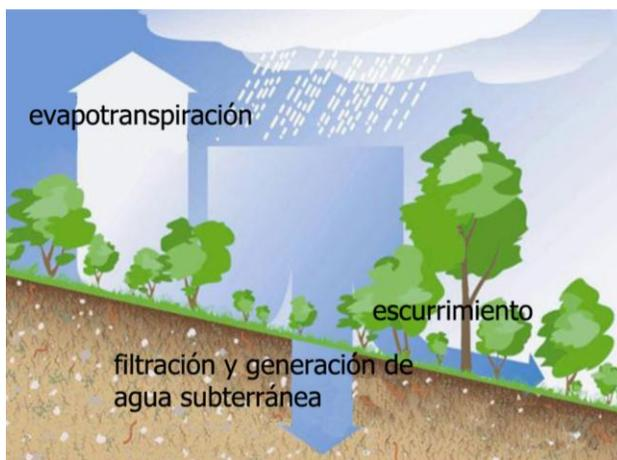
Figura 2: Infiltración de precipitación en superficies permeables
